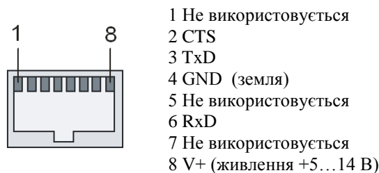
Малюнок 4. Призначення контактів роз'єму RS232
