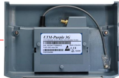
ETM Purple 3G під кришкою клемної коробки
